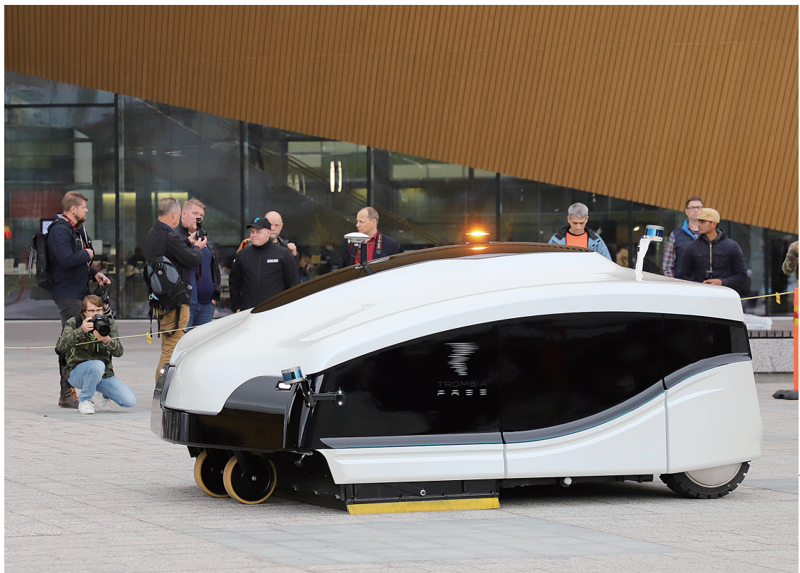
芬兰一家道路维护设备研发公司日前在赫尔辛基召开发布会,展示其研制的一款电力驱动的大功率全自动低碳扫路车,该车每小时最多可清扫约1.3万平方米区域。图为全自动低碳扫路车在发布会上进行试运行。新华社记者 朱晨晨摄
