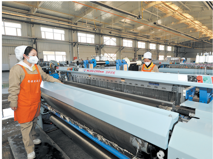
山西晋投玄武岩开发有限公司把技术创新能力作为核心竞争力的首要抓手,充分整合上下游产业资源,深入开展玄武岩纤维制品的应用研发,建立起“产、学、研、用”高效融合的研发体系,有效推动了玄武岩纤维的产业化发展步伐。图为纺纱车间工作人员正在有序生产玄武岩连续纤维。本报记者 于宏摄
