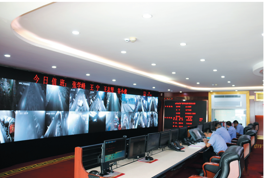
图为工作人员在矿调度指挥中心监控井下设备运行实时数据。 李小龙摄
