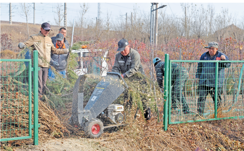
今年，位于平城区的韩家村森林公园采用堆肥化循环处理模式，利用粉碎机对公园及绿地中的绿化垃圾进行粉碎加工，并加入定量肥料、微生物菌剂、水，经过一至两个月时间，枝叶就变成了有机肥料。这些有机肥料对园林土壤的改良、花卉的栽植和山上树木的养护都将起到积极的作用。图为11月3日，工作人员正在对落叶、枯枝等绿化垃圾进行粉碎。
