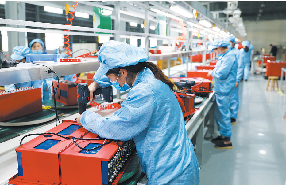
近年来，安徽省淮北市通过招商引资积极发展锂电池相关产业，形成涵盖锂电池材料、电芯、隔膜、终端应用产品的产业链条。图为在安徽省淮北市高新技术产业开发区，工人在一家5G通信基站储能锂电池生产企业的车间内组装锂电池。
