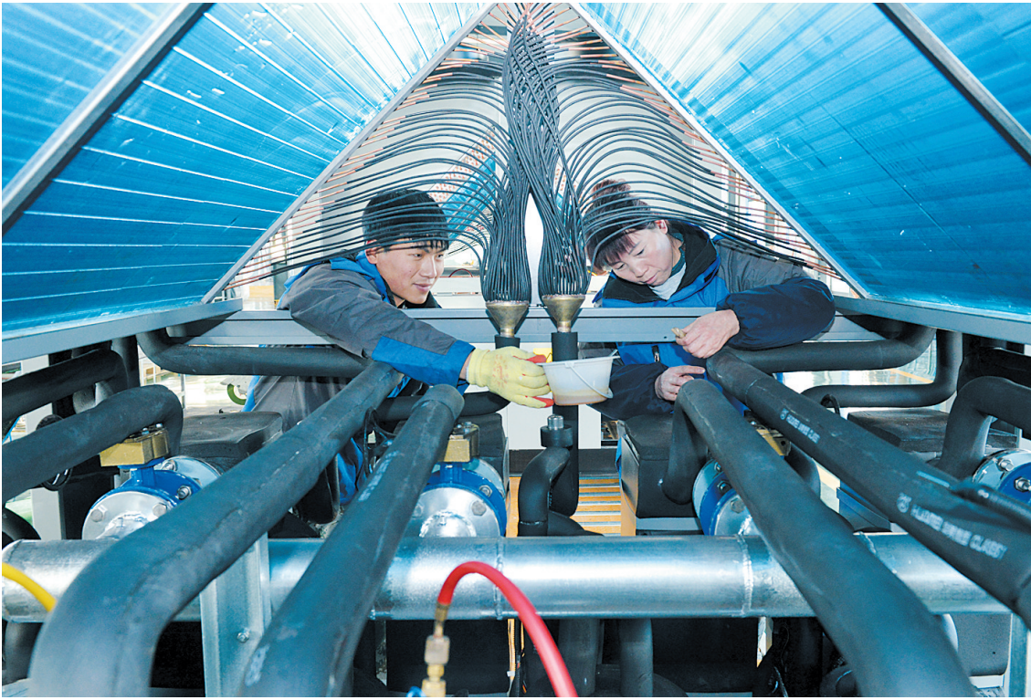
大同市悦凌空调有限公司瞄准国际制冷行业创新趋势，在现有空调制冷技术基础上，不断提升企业自主创新能力和内生发展动力，先后研发制造出了悦凌洁净新三能系列产品及超低温空气源热泵机组等，解决了空气源热泵机组不能在超低温条件下启动的难题，大幅提高了清洁能源利用效率。图为该公司工作人员正在为超低温空气源热泵采暖机组管路做保温层。
