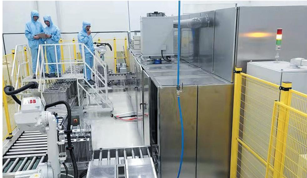
大同新研氢能源科技有限公司致力于推动氢能和燃料电池产业发展，有目前国内唯一拥有自主知识产权的金属板燃料电池电堆自动化生产线。图为新研氢能源科技有限公司制造车间内，工人正在对清洗的极板进行记录。
