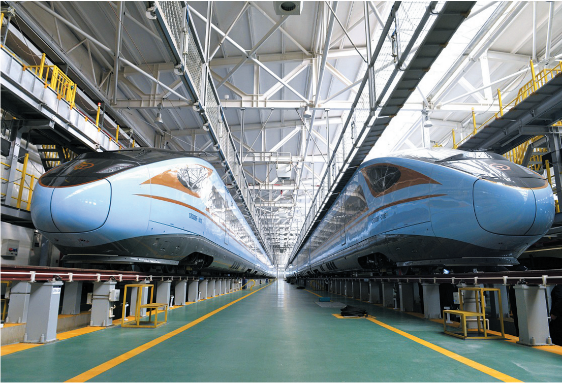
这是2020年12月23日在中国铁路兰州局集团有限公司兰州车辆段银川动车运用所拍摄的CR300BF型“复兴号”动车组。日前，共计三组CR300BF型“复兴号”动车组抵达银川，担负即将开通的银西高铁旅客运输任务。据了解，CR300BF型“复兴号”动车组，是中国标准动车组系列产品之一，设计最高运营时速250公里。 新华社发
