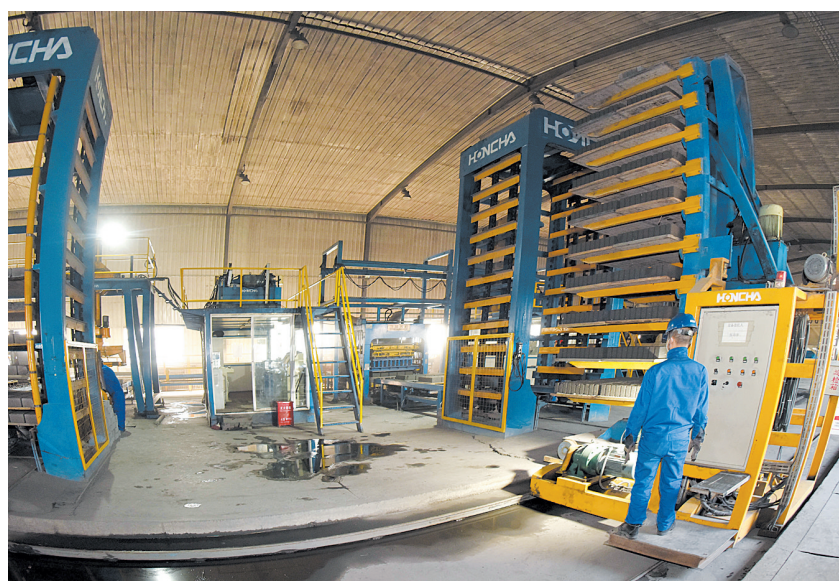
大同富乔垃圾焚烧发电有限公司将城市垃圾焚烧过程中的副产品炉渣变废为宝、化害为利,掺入骨料,做成免烧砖。图为工作人员正在养护免烧砖。
