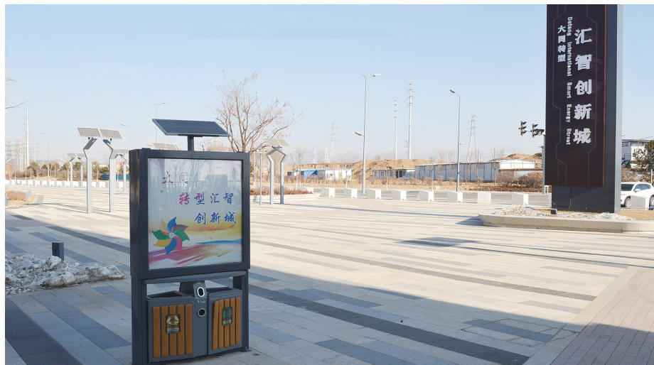
汇智大街分布放置的12个太阳能分类垃圾箱,顶部有一块太阳能板,可将太阳能转化为灯箱所需的电能,用于夜间照明;下方的垃圾箱内侧装有两个垃圾箱,标有“可回收”和“不可回收”字样。在对垃圾分类收集的同时,也增强了街区夜景亮化效果。图为汇智大街上的太阳能垃圾箱。本报记者 戎禹仁摄
