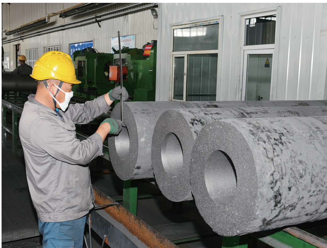
宇林德石墨新材料公司年产5万吨超高性能石墨电极项目，是我市转型发展和工业振兴取得的又一重大成果，填补了国内直径600mm以上超高性能石墨电极的空白，改变了这一产品长期依赖进口的历史，为我市工业新增了一个令人瞩目的拳头产品。产品销往国内20多个省、市、自治区，还出口南美、欧盟、中东、东南亚等国家和地区，已成为同行业中突起的新军。图为超高性能石墨电极生产线。 本报记者 戎禹仁摄
