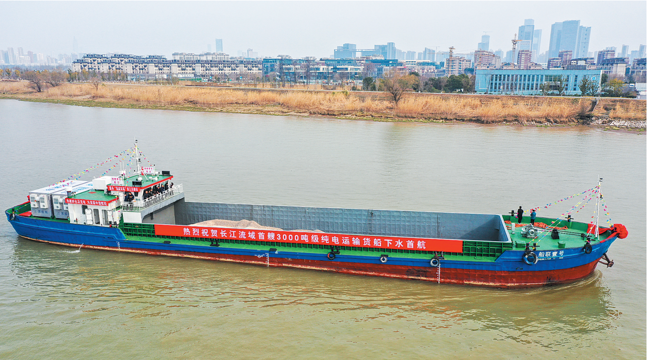
2月22日，“船联1号”电动货船在长江南京段航行（无人机照片）。当日，长江流域首艘3000吨级纯电动货船“船联1号”在南京首航。该船由原来总载重3000吨位的燃油货船改造而成，把电能作为整艘船的唯一能源，实现零排放、低噪音、无污染。
