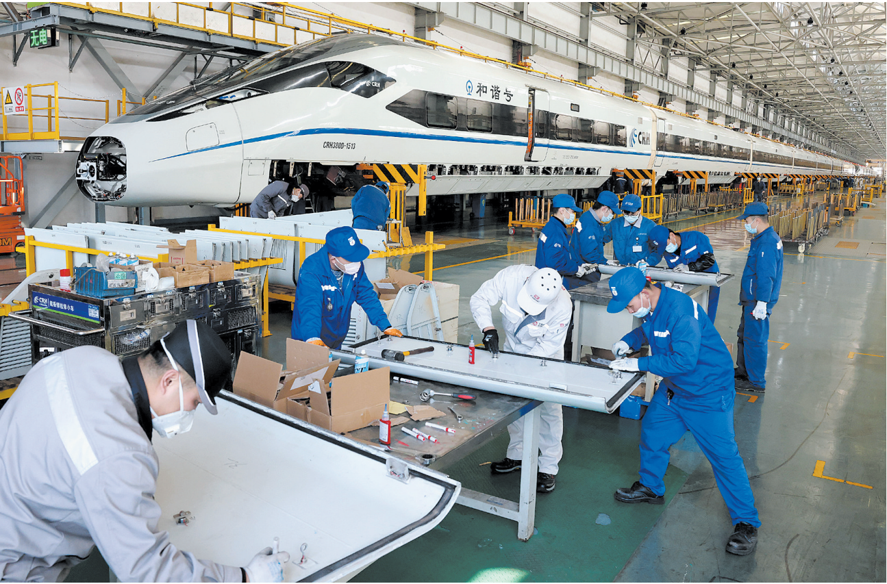
2月28日,技术人员对高铁列车裙板进行检修。随着2022年春运落下帷幕,铁路上海动车段高级场基地迎来首批6列高铁动车组进场深度检修。专业工程师和高铁检修技术人员对列车各部件进行“专家门诊”级的分解探伤和维护,确保高铁动车组不留故障隐患,再次安全上路。
