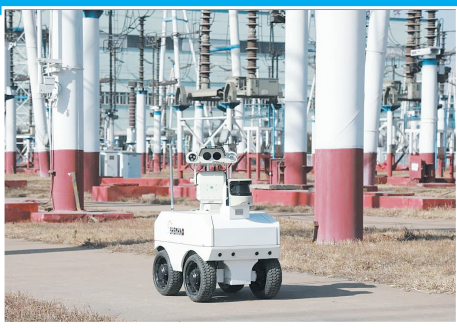
智能机器人巡检升压站设备。
