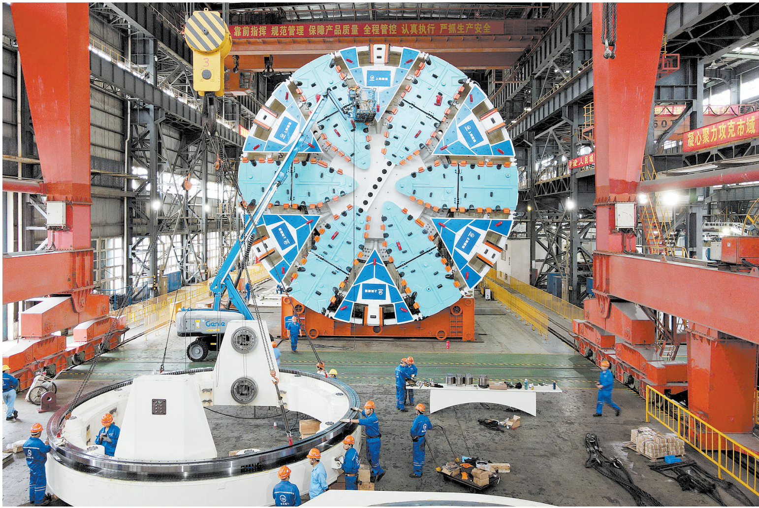
“麒麟号”位于上海浦东新区的隧道股份机械制造分公司生产车间进行安装调试（无人机照片，2020年10月15日摄）。当日，上海市域铁路机场联络线“梅富路工作井—华泾站”区间率先贯通，标志着由上海隧道自主研发制造的超大直径盾构机“麒麟号”“首秀”圆满完成。 新华社记者 方喆摄
