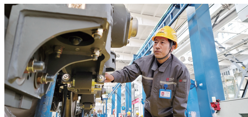
张志和正在对制造中的机车转向架进行检查和分析。（资料图片） 蒋维摄
