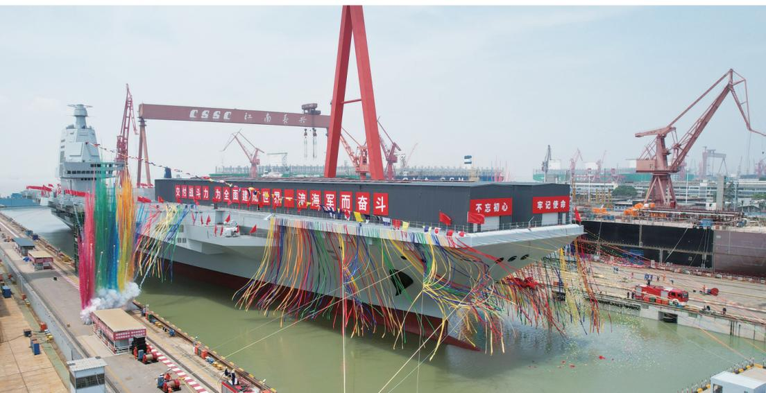
6月17日上午，我国第三艘航空母舰下水命名仪式在中国船舶集团有限公司江南造船厂举行。经中央军委批准，我国第三艘航空母舰命名为“中国人民解放军海军福建舰”，舷号为“18”。福建舰是我国自主设计建造的首艘弹射型航空母舰，采用平直通长飞行甲板，配置电磁弹射和阻拦装置，满载排水量8万余吨。该舰下水后，将按计划开展系泊试验和航行试验。图为下水命名仪式现场。新华社记者 李刚摄
