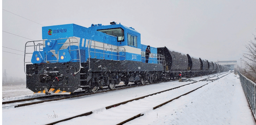
图为在锦白铁路上安全运行的全国首台氢燃料电池混合动力机车。 韩智慧摄
