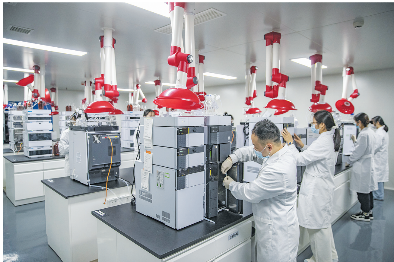
12月16日，在重庆市永川区新领先（重庆）生物医药一体化研发服务基地，新领先重庆研究院的研发人员在液相区对样本进行色谱分析。
