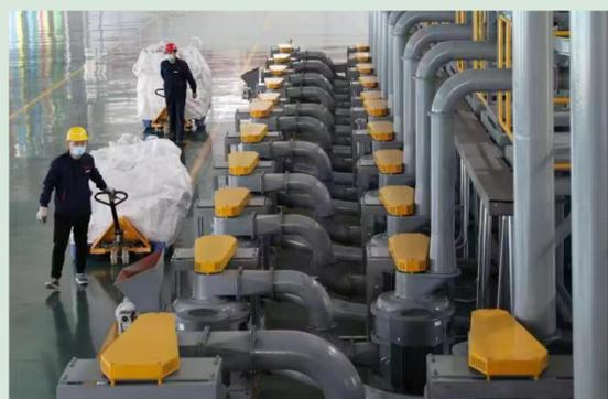
大同氢都拓新能源有限公司专业从事锂离子电池负极材料研发、生产与销售，图为制球车间第一条生产线。
