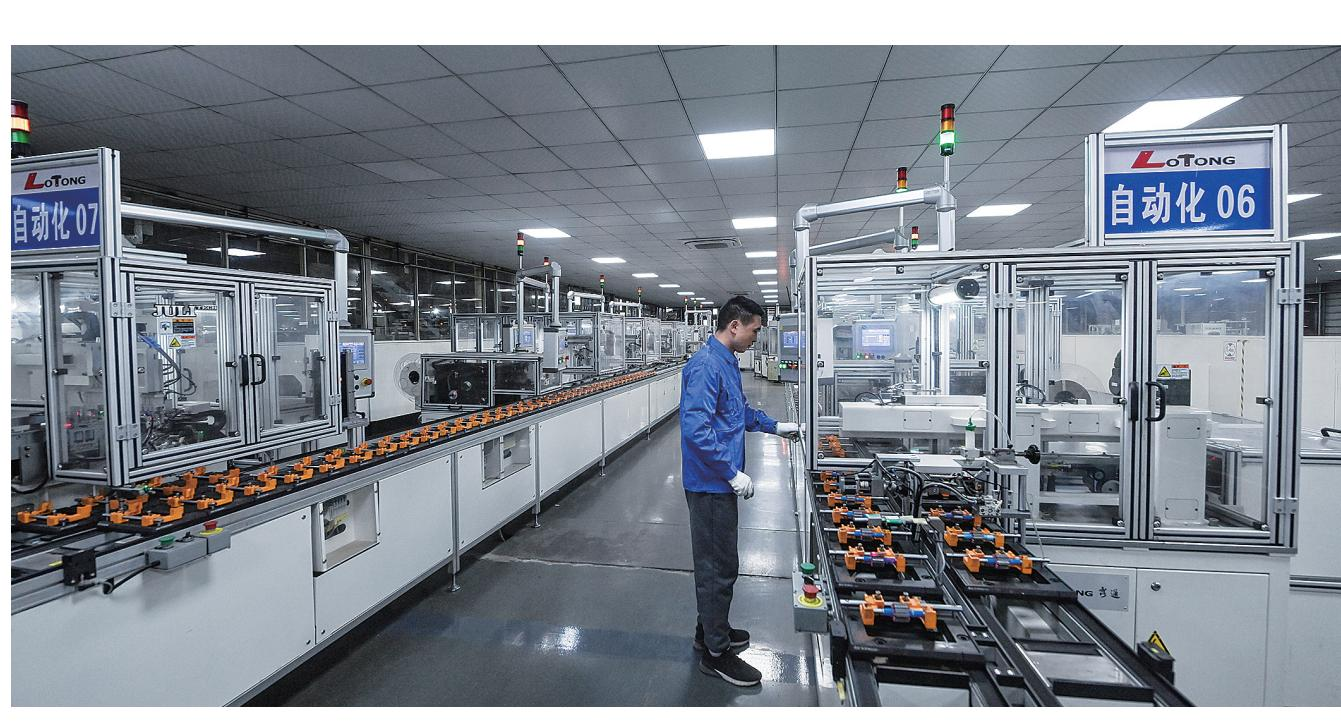
2月7日，在位于诸暨市姚江镇的浙江露通机电有限公司数字化车间内，自动化生产线正在运行中。该公司已完全实现自动化流水线12条，每条流水线由12人操作减少为1人操作，极大提高了生产效率和良品率。
