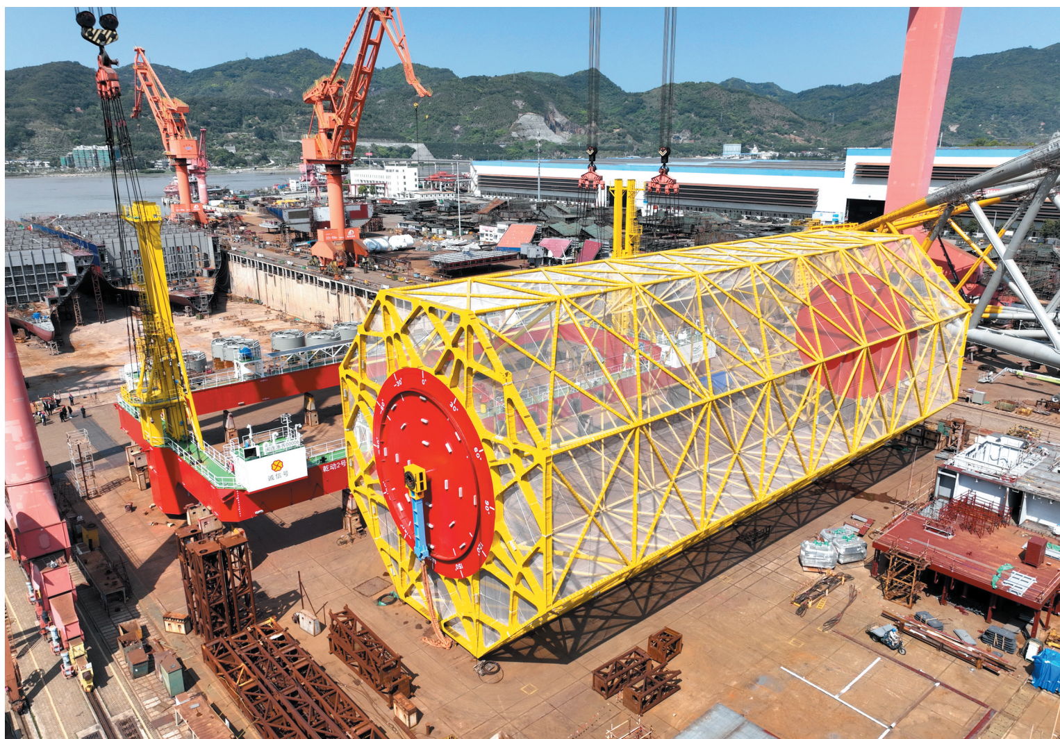
4月9日，“乾动2号”深远海养殖平台下水仪式在位于福建福州市连江县粗芦岛的马尾造船股份有限公司举行。“乾动2号”总长67.6米、总宽33.9米，搭载了各类智能养殖系统及检测系统等现代化渔业生产设备，所有数据可无线传输到养殖户手机终端上，实现智慧养殖。新华社记者 林善传摄
