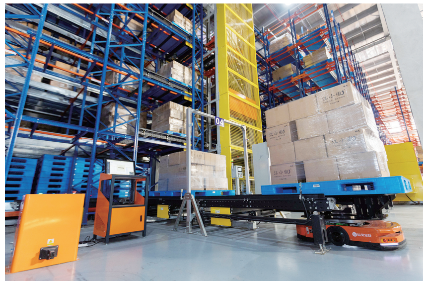
11月28日，5G智能运输车在宠物食品仓库中工作。5G智能运输车可自动匹配需求，实现24小时无人化作业，提升仓储运输效率。
