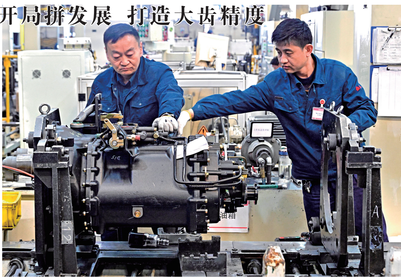
图为中国重汽集团大同齿轮有限公司试车加工位,员工正在为变速箱加注齿轮油,保证后续检测过程中齿轮传动系统充分润滑,变速箱质量和性能符合要求。本报记者 李冬寒摄
