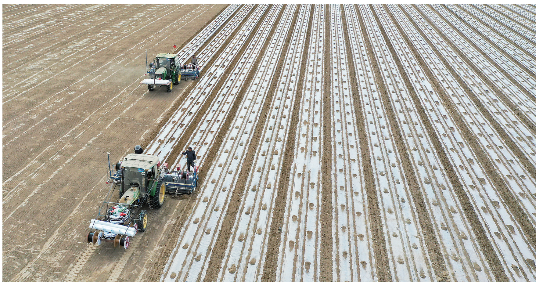
在新疆阿克苏地区阿瓦提县高标准农田核心区示范区，搭载导航自动驾驶系统的精量播种机在棉田春耕(3月27日摄，无人机照片)。
