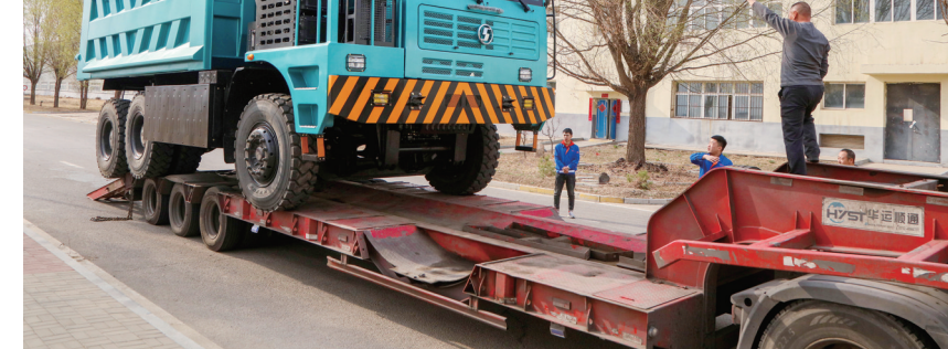
图为工作人员指挥自卸车驶上平板拖挂车。 本报记者 韩莹摄
