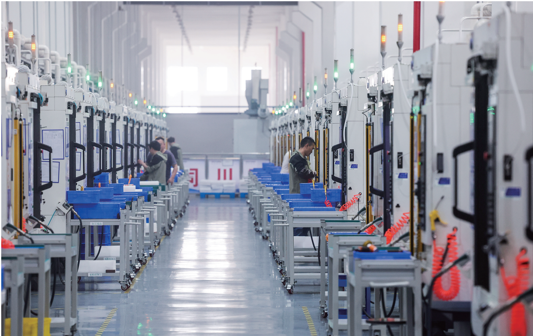
4月16日，在位于诸暨市陶朱街道的海特信科新材料科技有限公司车间内，自动化车床上在生产用于新能源汽车的针式散热器铜基板。近年来，浙江省诸暨市陶朱街道积极培育高新技术企业，招引高科技产业项目，打造高科技特色产业集群。
