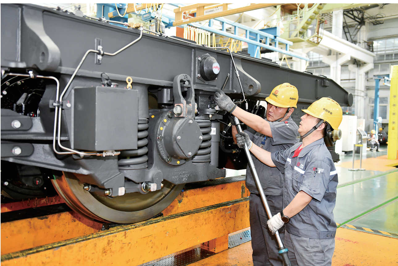
5月6日，中车大同电力机车有限公司生产分厂内机器轰鸣、弧光闪烁，多条生产线“全力开跑”，一派热火朝天的生产景象。面对新一轮机车检修任务，坚守在工作岗位上的“同车人”用汗水和担当诠释“劳动最光荣”。图为该公司转向架分厂员工进行轴箱拉杆螺栓紧固。
