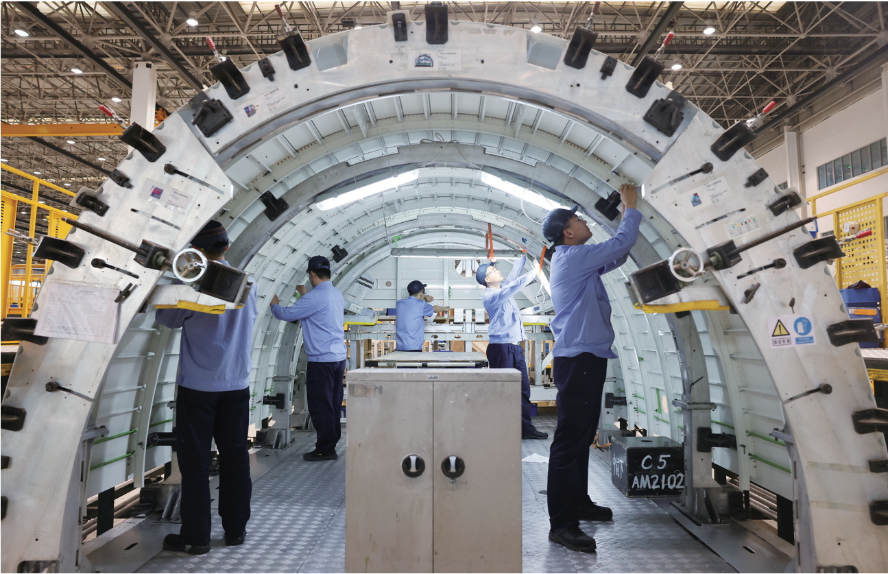
在航空工业沈飞飞机车间，工作人员进行机身壳铆接作业（4月25日摄）。沈阳目前已建立起涵盖航空发动机整机、民用飞机大部件转包和零部件制造、通航及无人机整机以及航空运营和维修服务于一体的全产业链航空体系。未来，沈阳还将依托现有产业基础，加快培育壮大低空经济产业集群，培育发展低空经济，展现辽宁新质生产力发展新活力。新华社记者 杨青摄
