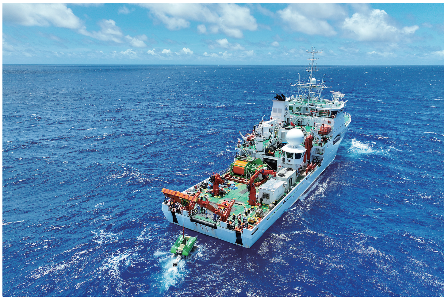
上海交通大学自主研发的深海重载作业采矿工程样机“开拓二号”海试现场（无人机照片，6月22日摄） 日前，我国深海矿产资源开发关键技术研究突破，由上海交通大学自主研发的深海重载作业采矿工程样机“开拓二号”成功完成海试。“开拓二号”连续完成5次着底采矿，取回深海多金属结核与结核，实现深海重载作业采矿工程海试首次突破4000米，最长达4102.8米，在国内首创深海复杂海底地形高机动行进、深海多矿类复合钻采等深海采矿领域多项技术。 新华社发
