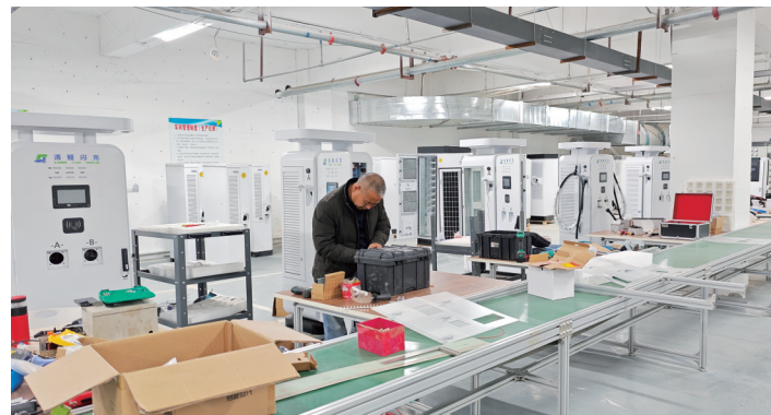
图为工作人员正在为大功率充电桩做最后的调试工作。本报记者 闫昌摄
