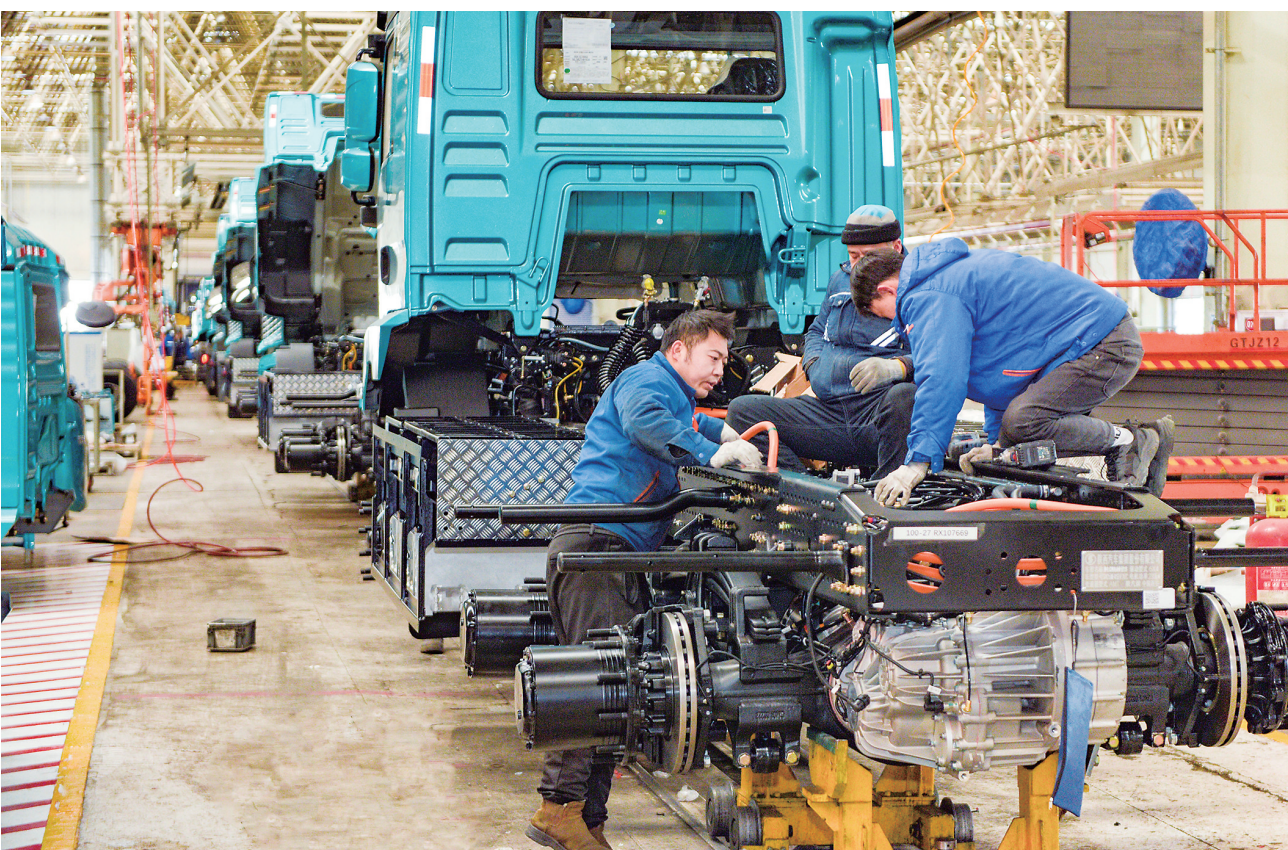
图为工作人员正在装配换电重卡中后桥高压电路。
