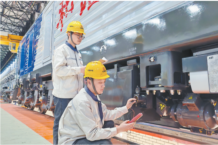
图为中车大同公司员工正在进行和谐型电力机车低压调试作业。韩云峰摄
