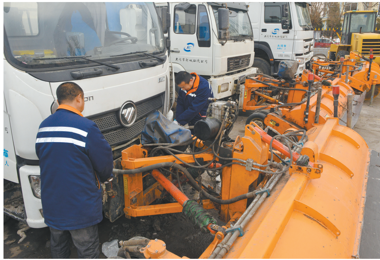
为应对即将到来的寒潮降雪天气,市新城环境卫生工程公司提前对清雪设备进行保养与调试,做好人员、设备、物资的调度部署,并结合辖区道路分布特点,优化调整清雪作业线路,确保降雪后能迅速启动清雪作业,优先保障重点路段通行,最大限度减少降雪对市民出行和城市运行的影响。图为工作人员正在对清雪设备进行维护保养。本报记者 戎禹仁摄
