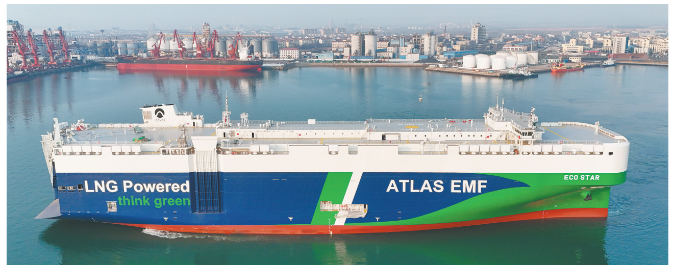
4月2日，7000车位双燃料汽车运输船“氢能之星”轮从山东港口烟台港龙口港区起航(无人机照片)。 4月2日，7000车位双燃料汽车运输船“氢能之星”轮在山东港口烟台港龙口港区投入运营。该船配备液化天然气(LNG)动力系统，同时采用“氨预留”设计，可在升级改装后使用清洁的氨燃料。该运输船由中集来福士为希腊一航运公司建造，3月30日交付后抵达龙口港区。 新华社发 (唐克摄)
