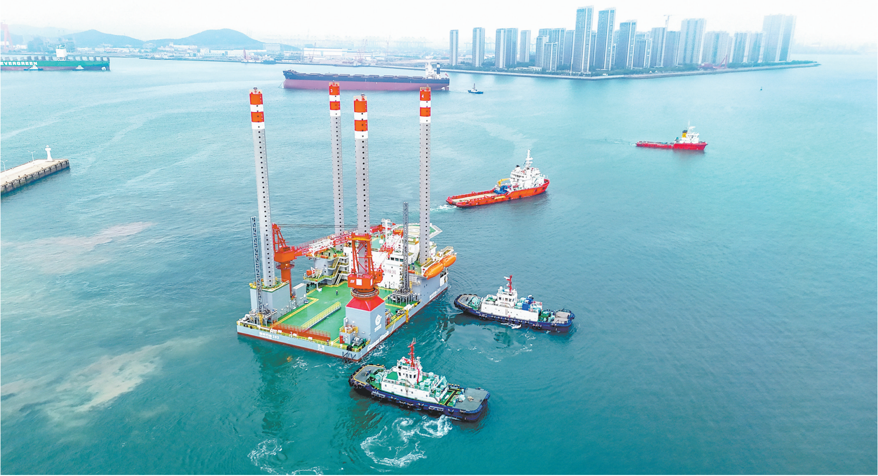
5月14日，我国首座海上移动式多功能措施平台“海洋石油283”从青岛西海岸新区启运(无人机照片)。 当日，我国首座海上移动式多功能措施平台“海洋石油283”(又称“增产一号”)从青岛西海岸新区启运，发往渤海油田。 该平台采用“移动式+模块化”设计，总重7300余吨，最大作业水深40米，集酸化、压裂、调驱、调剖、稠油热采等功能于一体，并引入AI智能监测，投用后将有效支撑渤海油田增储上产。 新华社记者 张进刚摄
