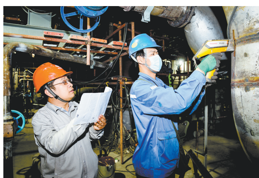
图为工作人员用工艺卡纸复核道焊材。
