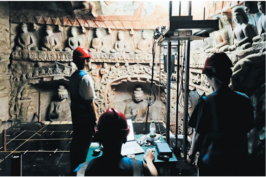
云冈石窟第7、8窟三维高光谱数据采集现场
