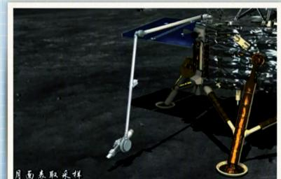
嫦娥五号此次将在月面选定区域着陆并采集月壤。设计师们为此精心设计了两种“挖土”模式：钻取和表取。顺利软着陆后，嫦娥五号将开始为期约2天的月面工作，采集约2公斤月壤并进行密封封装。
