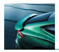
前大灯延伸至车身尾部,而后轮 眉与上腰线的搭配呈现出流动的 线条感。另外,新车的溜背式车 身从B柱平滑过渡至车尾,加上 大尺寸的五幅式轮毂,具有不错 的视觉冲击力。值得一提的是, 新车将采用无边框车门设计,不 仅能够让车门与整车很好地融为 一体,还能够进一步提升 MG7 的 时尚质感。另外,MG7还安装了 三段式主动运动尾翼,当速度达 到100km/h,尾翼会自动打开,提 供更稳定的驾控表现。
