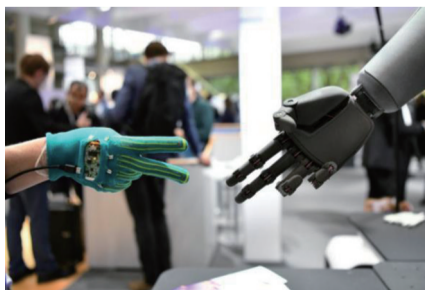
2022年5月30日，在德国汉诺威工业博览会上，一款智能机器人与观众互动。该智能机器人可感知一定空间范围内人的手势，并作出相同的手势。(资料图)
