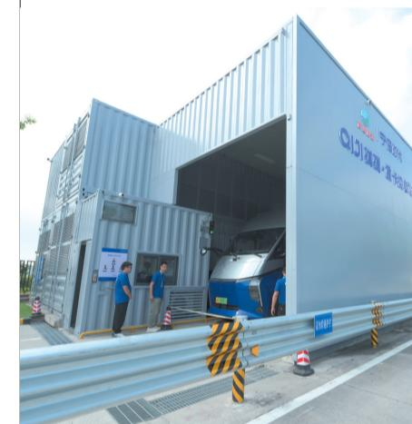
8月24日，采用底部换电技术的卡车在福州绕城高速公路长乐服务区的“骐骥·重卡换电站”换电。
