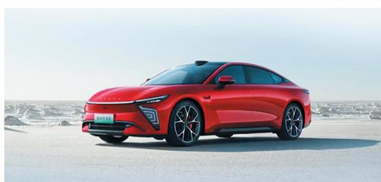
LED灯组的前车设计。前包围两侧像素点阵式LED模块配合中间倒梯形散热开口,整车显得相当时尚。车身尺寸的长宽高分别为4945mm、1978mm、1467mm,轴距为3000mm,风阻系数为0.205。
