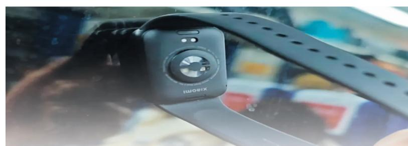
窗玻璃的表面不可能绝对光滑，比如手表表盘可能存在因贴膜没贴好而形成的气泡区。这时当表盘贴近车窗玻璃时，气泡区的气体会被排出，使该区域形成低压，甚至接近真空状态。此时，在大气压的作用下，智能手表就会被紧紧地压在车窗玻璃表面。
