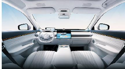
的需求，以宽敞舒适为要求，精心雕琢驾驶环境。其车身尺寸达到长4955mm、宽1975mm、高1698mm，轴距长达3000mm，贴近“532”级中大型SUV的尺寸，拥有3.45m³有效舱内空间。车辆拥有36处储物空间，其中智能电动手套箱支持智能语音及中控屏幕两种开启方式，并可设定密码开关。后备厢标准容积546L，配合空气悬架调节可便捷装卸大件物品。座椅放倒后的后排容积可扩展至1835L，轻松应对全家出游、露营、搬家等多元场景的空间需求。车顶部的天幕开口透光面积达1.27m²，双层纳米镀银隔热玻璃可有效隔绝99.9%紫外线与98.5%红外线。智能电动遮阳帘可通过车机和语音无级调节，实现通透与防晒兼得的功能。
